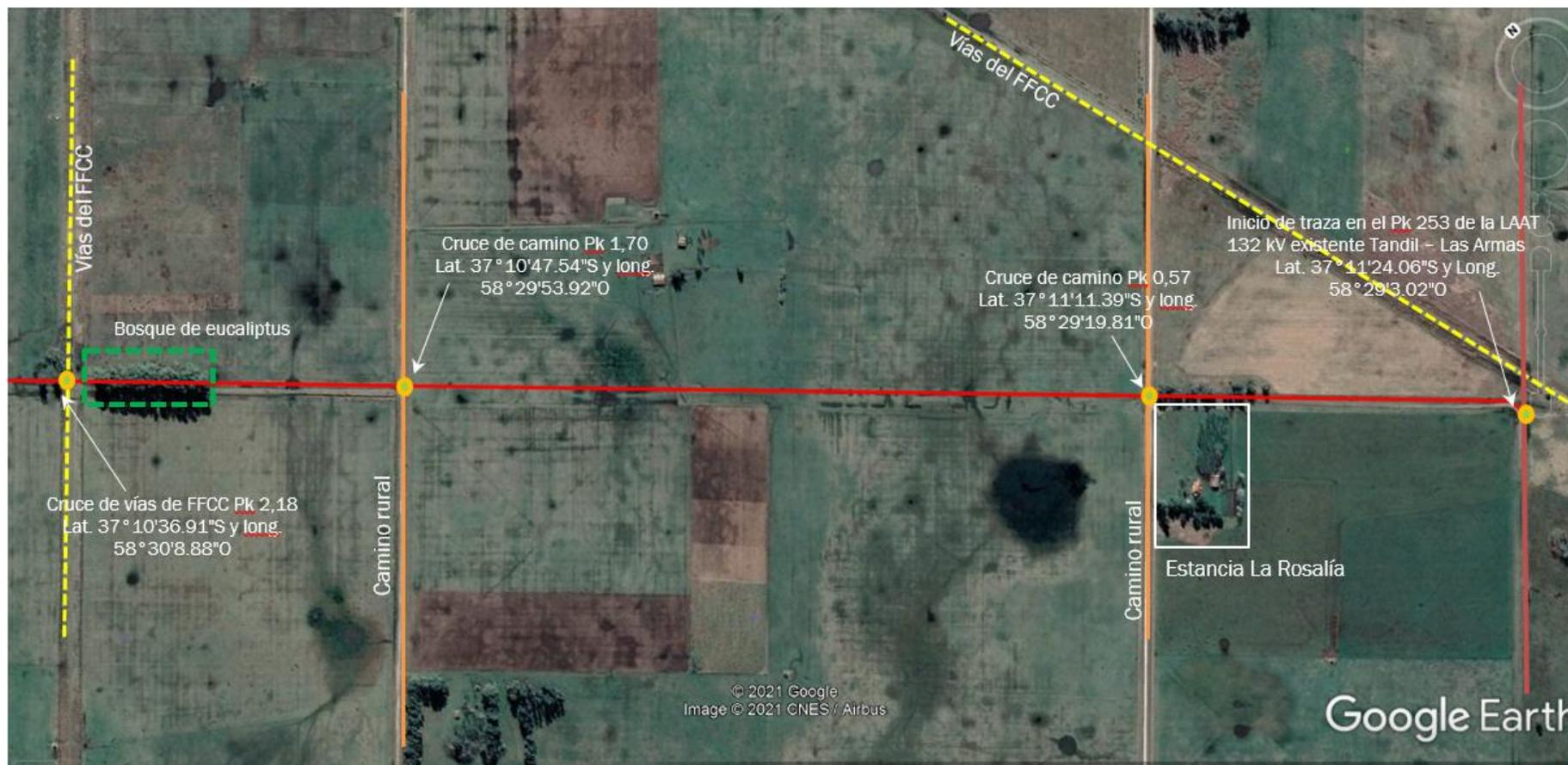
**Figura 5.** Imagen satelital donde se observa el tendido de la nueva LAAT 132 kV entre las progresivas 0,00 y 2,18
