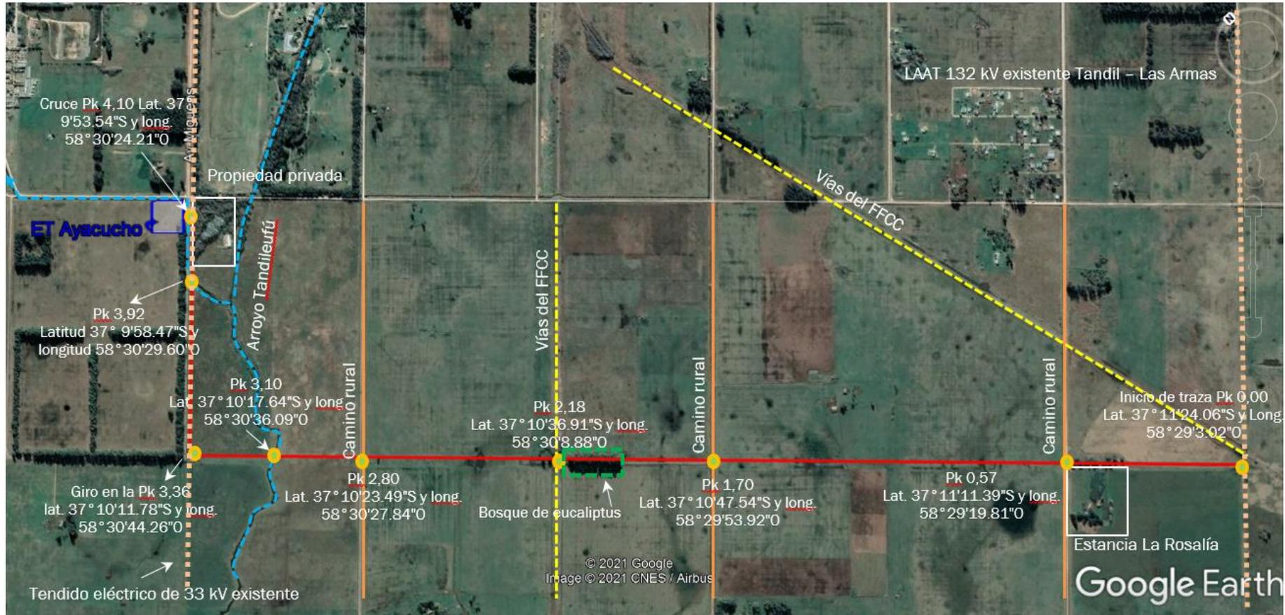
**Figura 4.** Imagen satelital con la vista general del tendido de la nueva LAAT 132 kV y Estación Transformadora (ET). Se identifica con coordenadas geográficas la ubicación de la infraestructura existente (viviendas, vías del FFCC, caminos de tierra y tendido eléctricos) y el cauce del arroyo Tandileufú.
